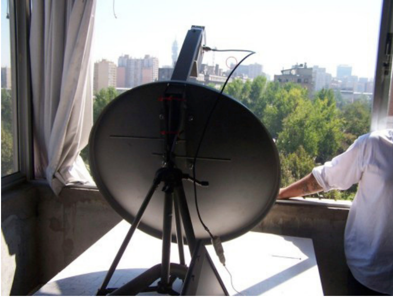
Figura 11.17: Estación wireless con antena parabólica usada para la transmisión de la FLISOL de Santiago 2006 mediante flujo continuo de video (streaming) con software libre.
