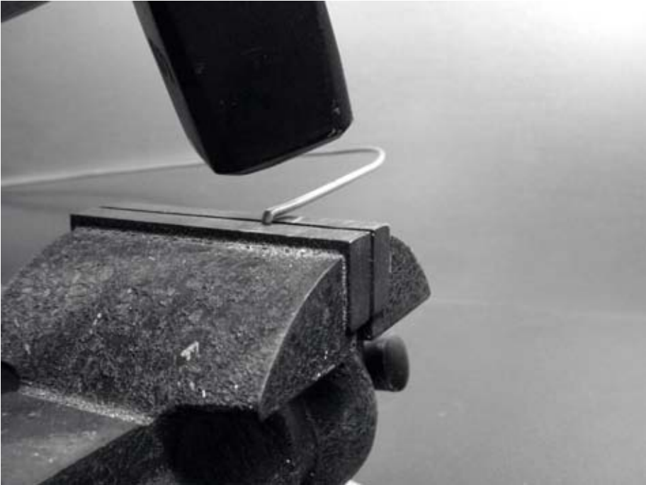
Figura 4.15: Golpee con delicadeza el alambre para hacer una curva cerrada.
