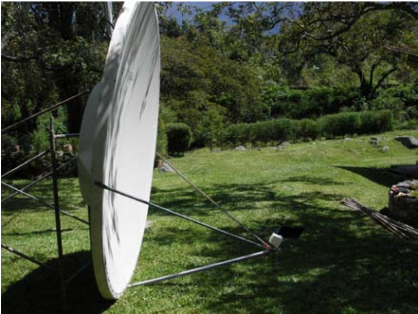
Figura 11.36: Reflector de 2,4 m con iluminación excéntrica y una antena de 12 dBi en su punto focal, mirando 14° hacia abajo. El ángulo real de elevación es de 8° hacia arriba.
