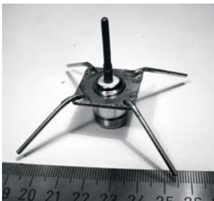
Figura 4.8: Antena de un cuarto de longitud de onda con plano de tierra.
