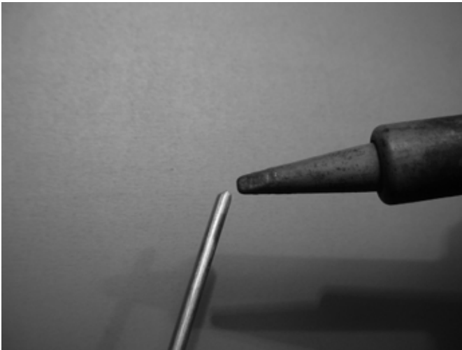
Figura 4.37: Estañe el extremo del alambre antes de soldarlo.
