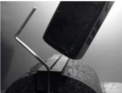
Figura 4.16: Doblar el alambre en forma de "Z".
