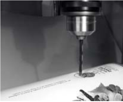
Figura 4.36: Taladre cuidadosamente un agujero piloto, luego use una mecha más grande para terminar el trabajo.
