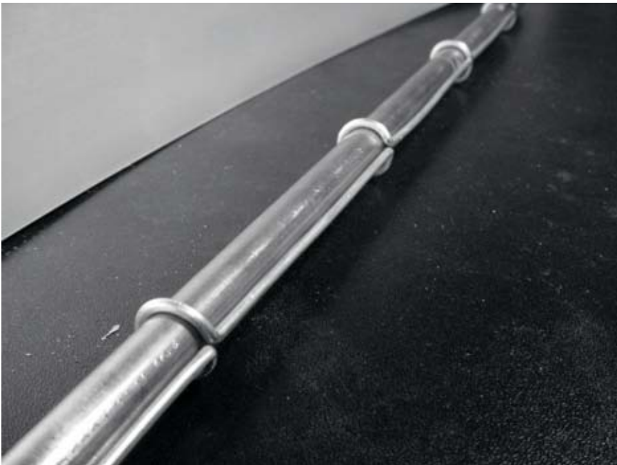
Figura 4.20: Insertar un tubo puede ayudar a enderezar el alambre.
