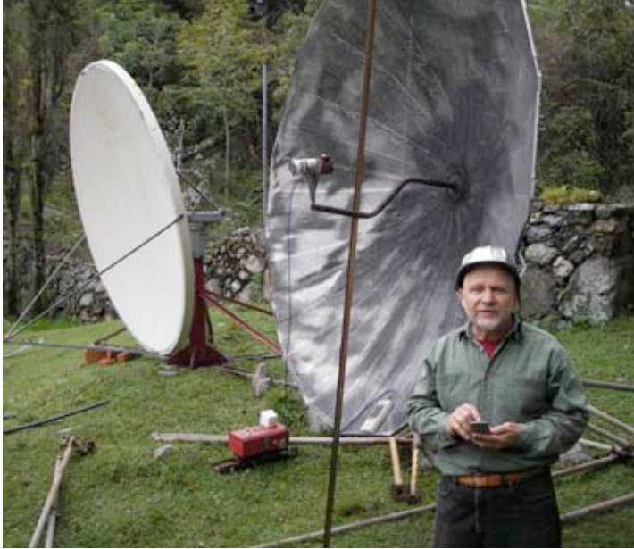
Figura 11.38: Hallando el foco de la antena con el iluminador de 2,4 GHz
