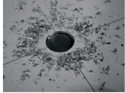
Figura 4.21: Taladrar el agujero en la placa de metal.
