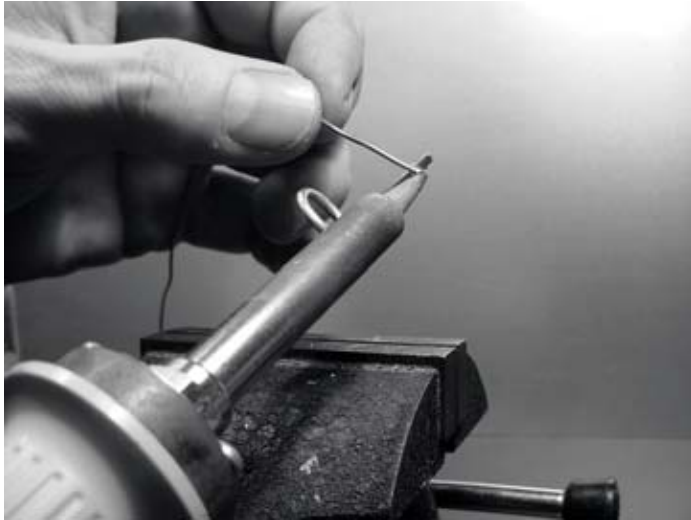
Figura 4.25: Agregue una pequeña capa de estaño al extremo del alambre antes de soldarlo.
