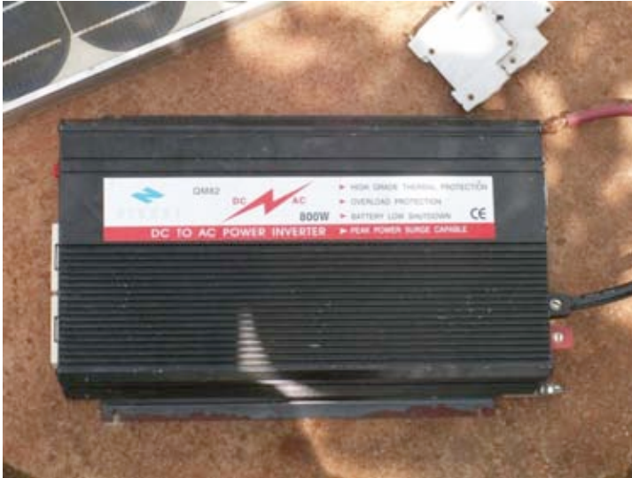
Figura 7.4: Convertidor DC/AC. Inversor con una potencia máxima de salida de 800 W
