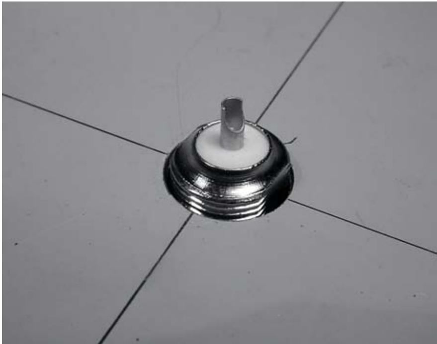
Figura 4.22: El conector N debe encajar exactamente en la perforación.
