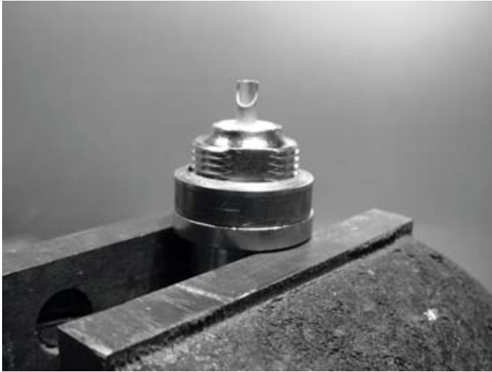
Figura 4.23: Agregar un tubo de cobre espaciador ayuda a obtener la impedancia de la antena de 50 Ohms.
