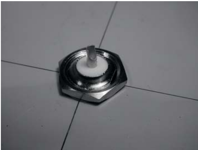
Figura 4.24: Asegure el conector N firmemente a la placa
