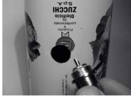
Figura 4.36: Taladre cuidadosamente un agujero piloto, luego use una mecha más grande para terminar el trabajo.
