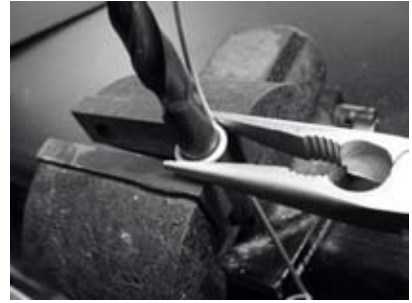
Figura 4.17: Curvar el alambre alrededor de un tubo para hacer un anillo.
