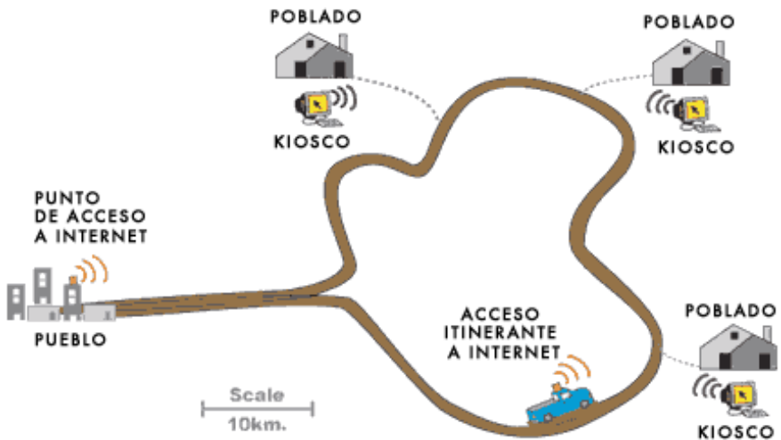
Figura 10.2: Punto de acceso itinerante de DakNet
