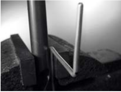
Figura 4.17: Curvar el alambre alrededor de un tubo para hacer un anillo.
