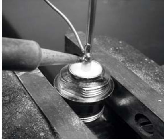
Figura 4.38: Suelde el alambre a la copa dorada en el conector N.
