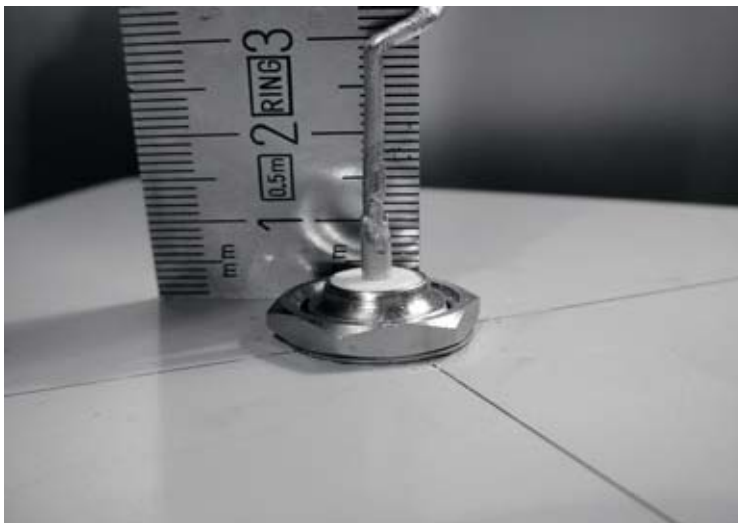
Figura 4.26: El primer anillo debe comenzar a 3,0 cm desde la superficie de la placa
