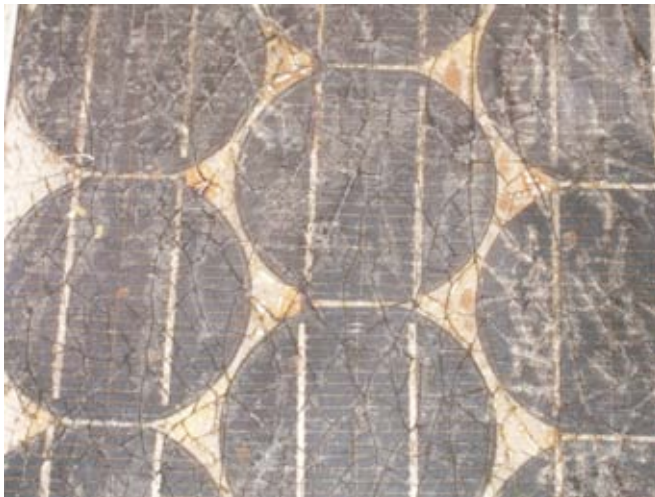
Figura 7.6: Efectos del agua y la corrosión en un panel solar
