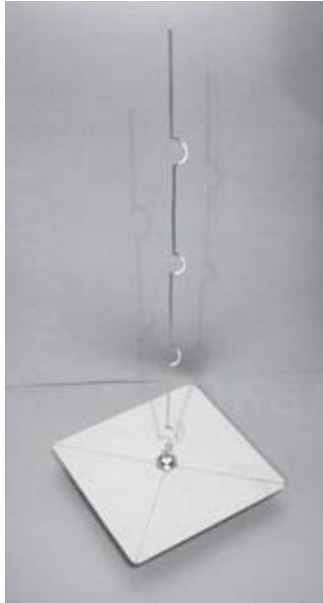
Figura 4.29: La antena terminada debe medir 42,5 cm. desde la placa hasta el final del alambre.
