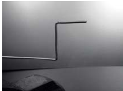
Figura 4.16: Doblar el alambre en forma de "Z".
