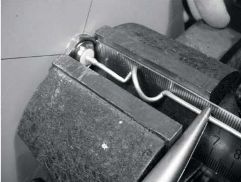
Figura 4.27: Estirar los anillos. Sea muy cuidadoso y trate de no raspar la superficie del alambre con las pinzas.
